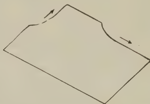
Fig. 6. Beschleunigung der Kristallisation durch Entstehung von krummen Flächen mit großer Wachstumsgeschwindigkeit.
